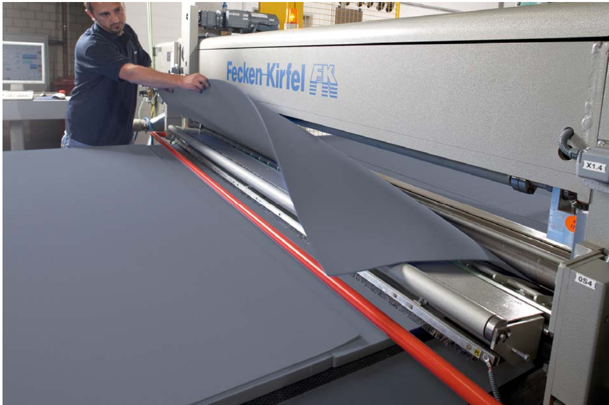
Bild 3: Spaltprozess von Zellgummi
